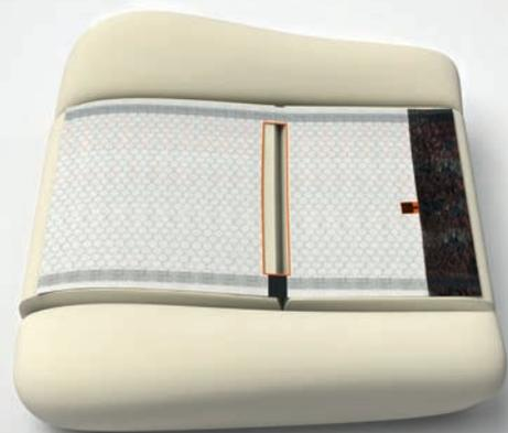
11. Schneiden Sie nun die Heizmatte in dem angezeichneten Bereich aus. Es ist sehr wichtig, dass die Heizmatte im Bereich des Abspanngrabens ausgeschnitten und nicht eingeschnitten wird.
