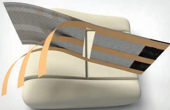
14. Wenden Sie die Heizmatte und entfernen Sie die Schutzfolie des doppelseitigen Klebebandes. Sollte der Schäumling noch silikonhaltige Rückstände (aus der Spritzform) auf der Oberfläche aufweisen und dadurch das doppelseitige Klebeband nicht ausreichend haften, so reinigen Sie den Schäumling und kleben Sie die Heizmatte mit Hilfe eines geeigneten Klebers vollflächig auf.
