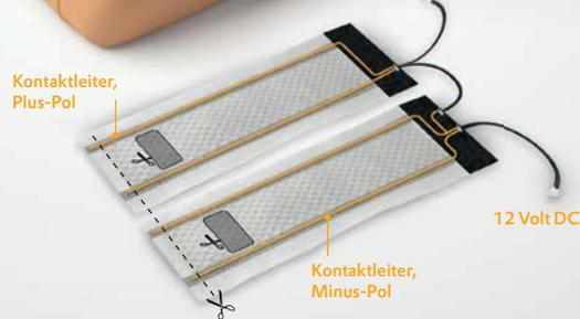
Die Heizmatte kann in der Länge gekürzt werden. Es ist auch möglich, die Heizmatte in Querrichtung auszuschneiden. Dabei ist die Position der Ausschnitte auf der Heizmatte beliebig wählbar.
